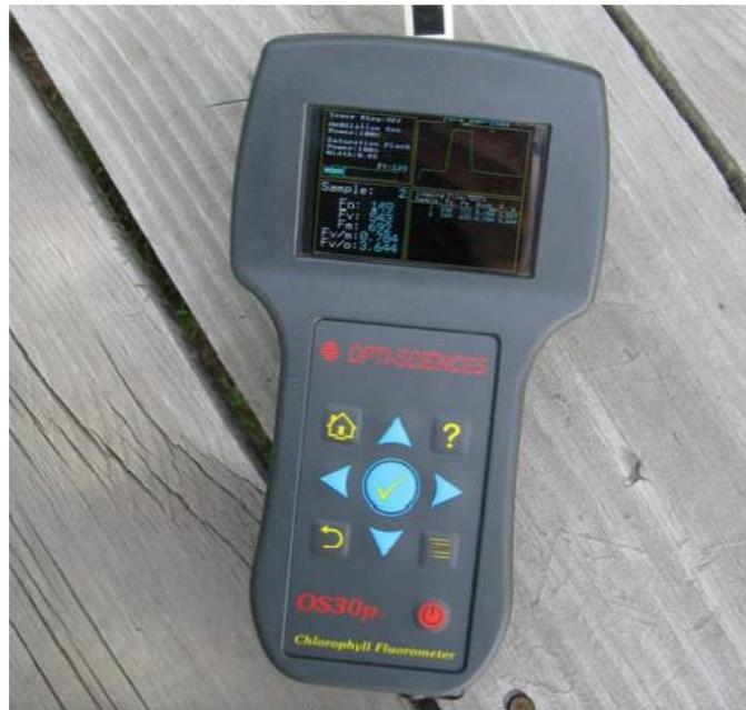
**Figure 9:** L'appareil de mesure OS-30p+ de la fluorescence chlorophyllienne utilisé
