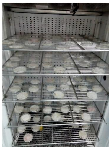
**Figure 15:** Germination des graines de blé dur effectuée dans une chambre de germination à  $20 \pm 1$  °C et à 84 % d'humidité relative (HR)
