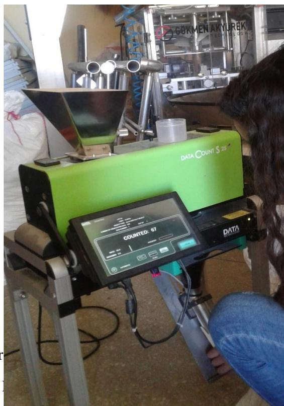
**Figure 12 :** Compteur automatique de grains pour la détermination du poids de mille grains. Après la récolte des deux génotypes, le poids de 1000 grains a été déterminé à la station Marchouch en utilisant un compteur automatique de type Data Count S25 qui nous permet de dénombrer 1000 grains et par la suite les peser en utilisant une balance.
