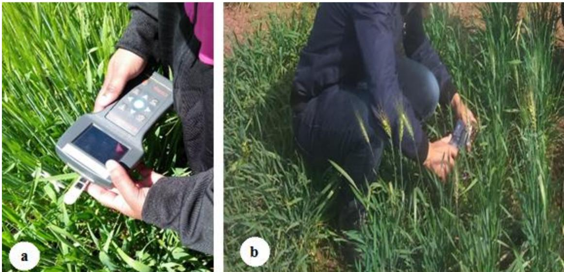
**Figure 8 :** Méthode de prise des mesures de la fluorescence chlorophyllienne au champ (a) à la station Marchouch, et (b) à la station Wad Medani, par le fluoromètre type OS-30p+
