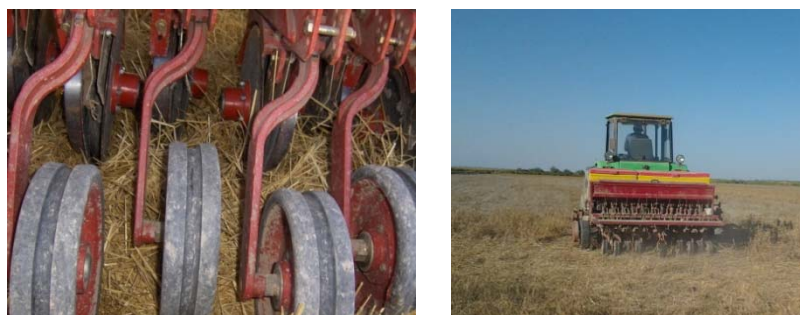
Рис.4. Сев озимой пшеницы с помощью нулевой сеялки «Vence TUDO» SA 11500.
