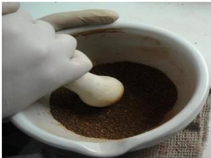
**Figure 26.** Broyage et pilonnage de l'échantillon
