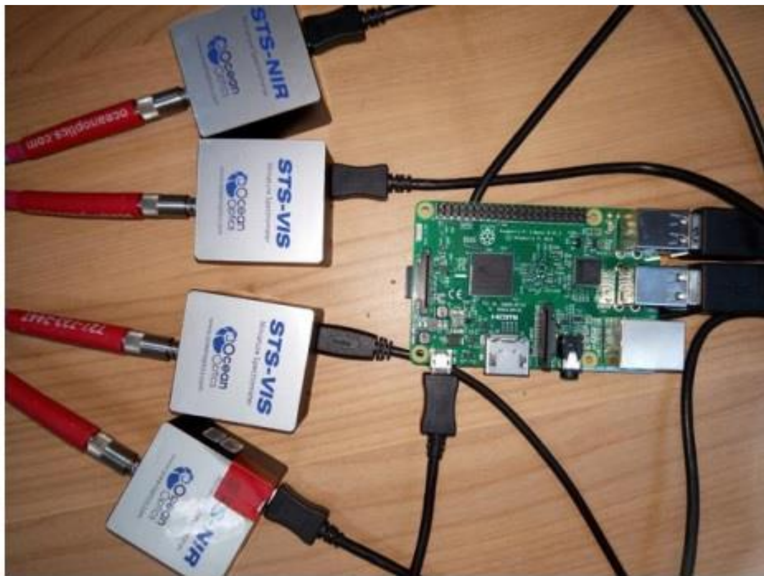
Figura 9. Conectarea celor patru mini spectrometre la Raspberry Pi 3
