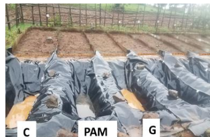
Expérience sur l'efficacité des amendements de sol C : Contrôle ; PAM : Polyacrylamide, G : Gypse
