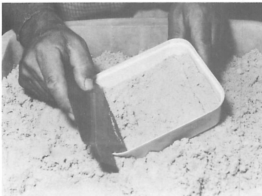
Fig. 1 La boîte est remplie de sable mouillé et nivelé à l'aide d'une raclette.
