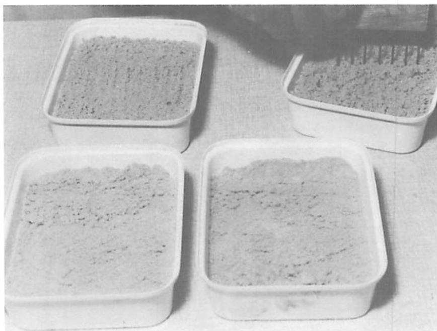
Fig. 2. Le lit de sable est ratissé à l'aide d'une raclette.
