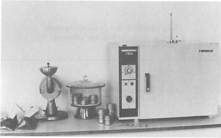
Fig.1 : Équipement destiné à mesurer l'humidité.
