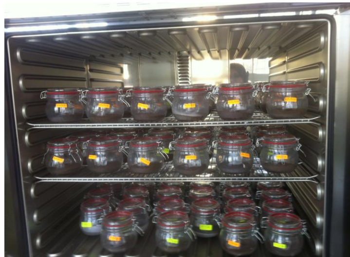
Figure 2 : Processus d'incubation du sol au laboratoire.
