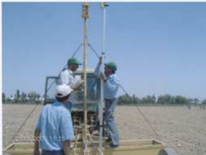
Фото 1 Лазер ускунани ертекислаш иши вақтида солаш.
