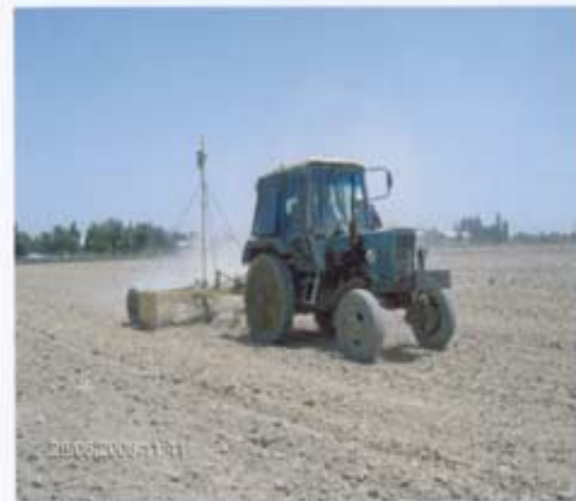
Фото 2 Лазер ускунадан фойдаланиб ерни текислаш.
