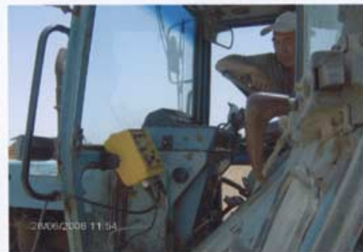
Фото 3 Трактор кабинасида лазер ускунасини назорат системаси.
