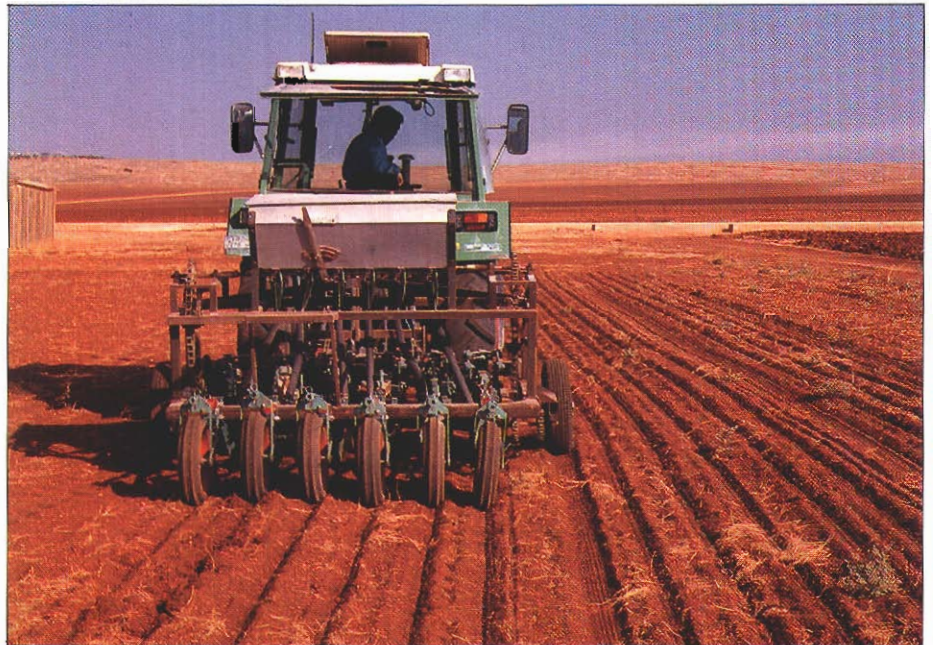
تم في إيكاردا تجميع بذارة تبذر في الأرض الجلد ( غير المفلوحة ) ، وذلك باستخدام مجموعات متكاملة مستوردة ، وصندوق بذار مصمّم محلياً .
