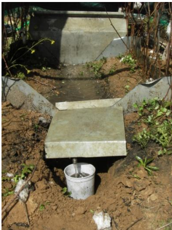
Figura 11. Simulación de lluvia con el surco marcado con magnetita.
