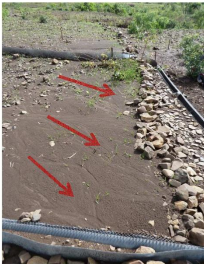
Figura 9. Efecto del dique de piedra en una de las parcelas (adaptada de Strohmeier y col. 2015).
