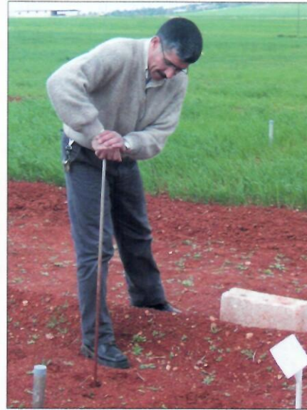
عصا الماء عبارة عن مسبر متدني الكلفة وسهل الاستخدام لتقدير رطوبة التربة وتراصها.
