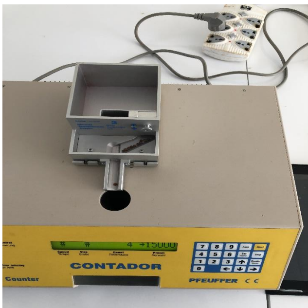
Figure 31. Machine pour compter le nombre de graines
