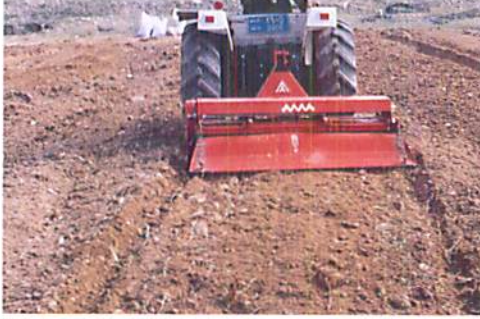
شكل رقم 8: تغرم التربة و يكسر الكدر باستخدام الروتوفيتير.
