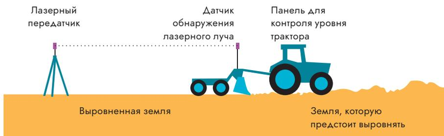
**Рис. 3:** Схематическое изображение лазерной планировки земель
